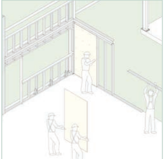
1|2 Paneles planta baja
